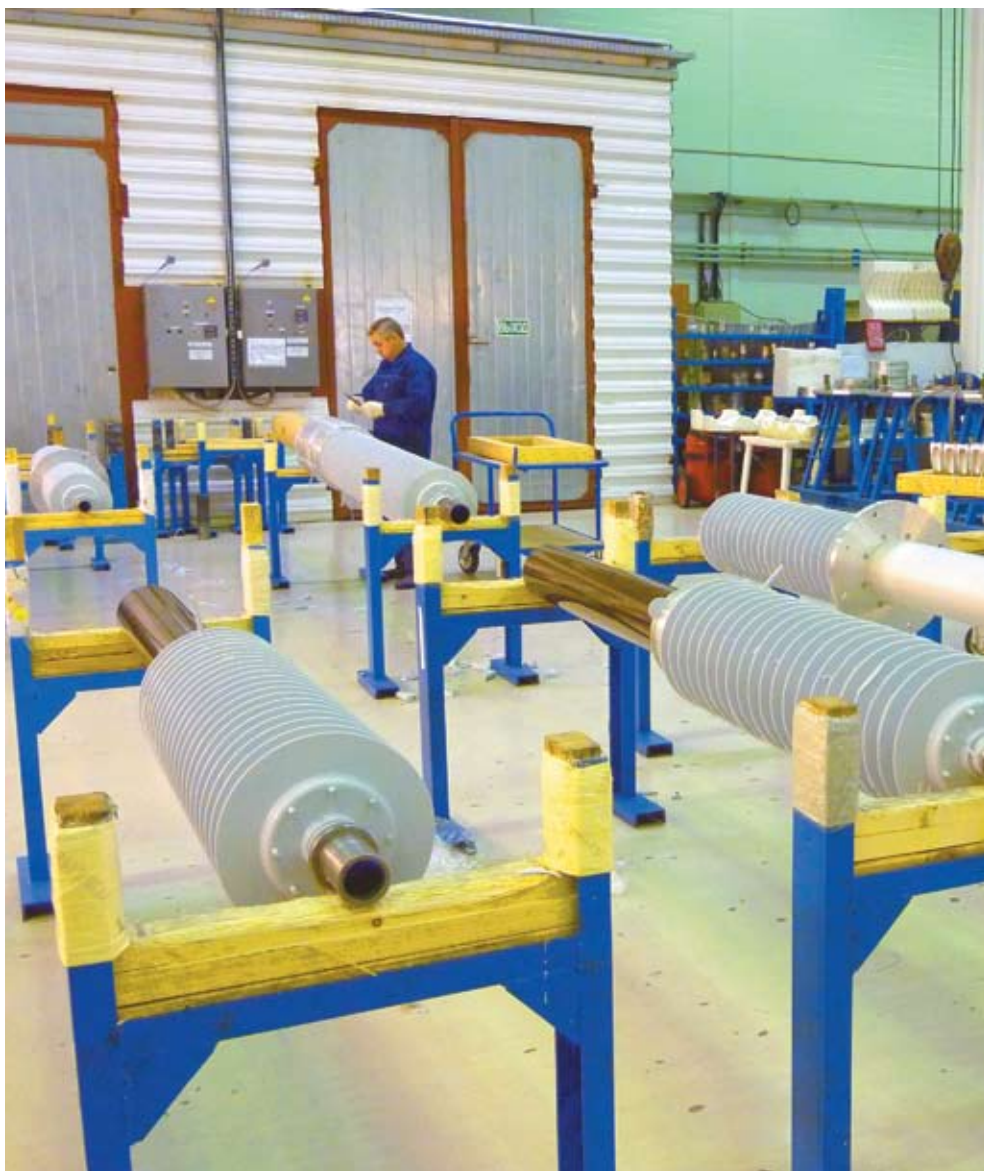
Вводы «Изолятор» 110 кВ с полимерной внешней изоляцией
