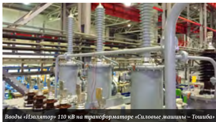
Вводы «Изолятор» 220 кВ на трансформаторе «Силовые машины – Тошиба»
