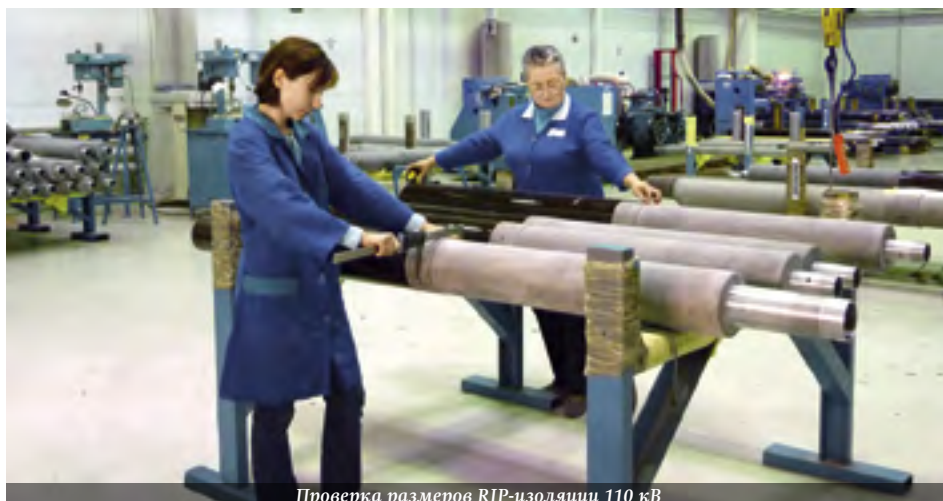
Проверка размеров RIP-изоляции 110 кВ
