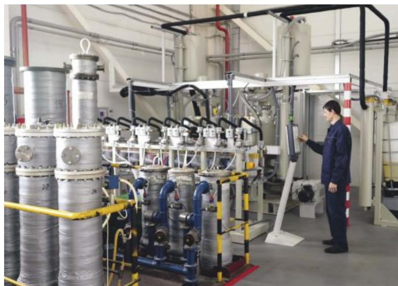
Рис. 12. Машина Hubers для вакуумной пропитки изоляции на заводе «Изолятор»
