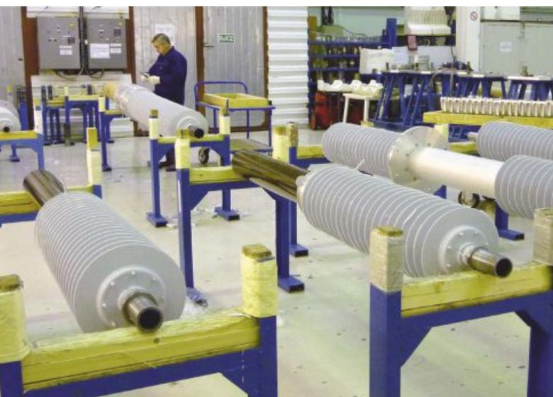
Рис. 16. Подготовка к контролю качества полимерной изоляции на заводе «Изолятор»
