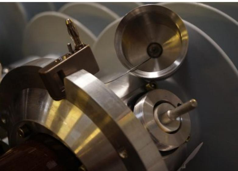
Рис. 10б измерительный вывод со снятым колпаком
