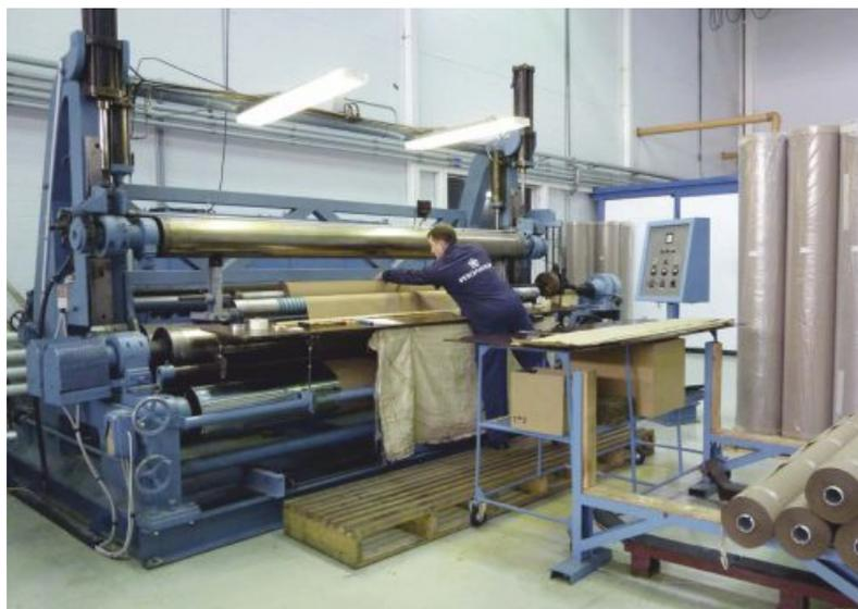
Рис. 11. Намотка бумажной изоляции 110 кВ широким полотном на заводе «Изолятор»
