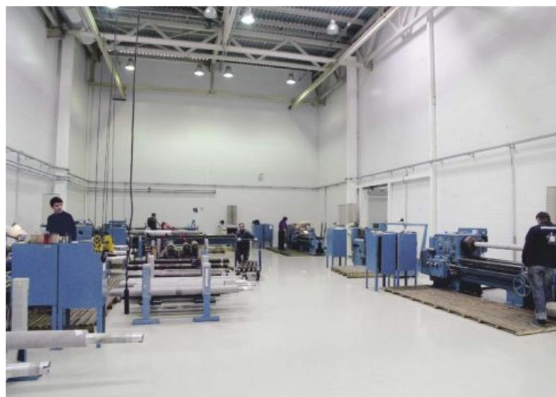
Рис. 13. Участок механической обработки RIP-изоляции 35–220 кВ на заводе «Изолятор»
