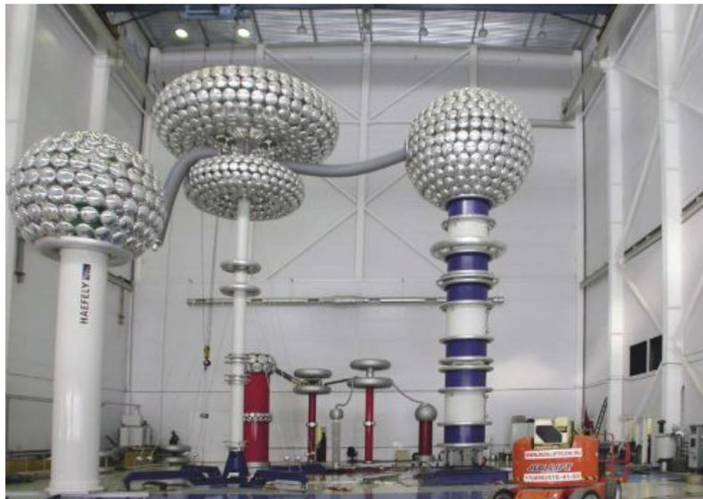
Рис. 17. Участок испытаний вводов 220–1150 кВ на заводе «Изолятор»
