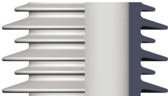
Рис. 4. Профиль фарфоровой покрывки
