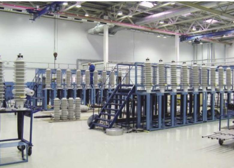
Рис.14. Сборка вводов 110 кВ с фарфоровой внешней изоляцией на заводе «Изолятор»
