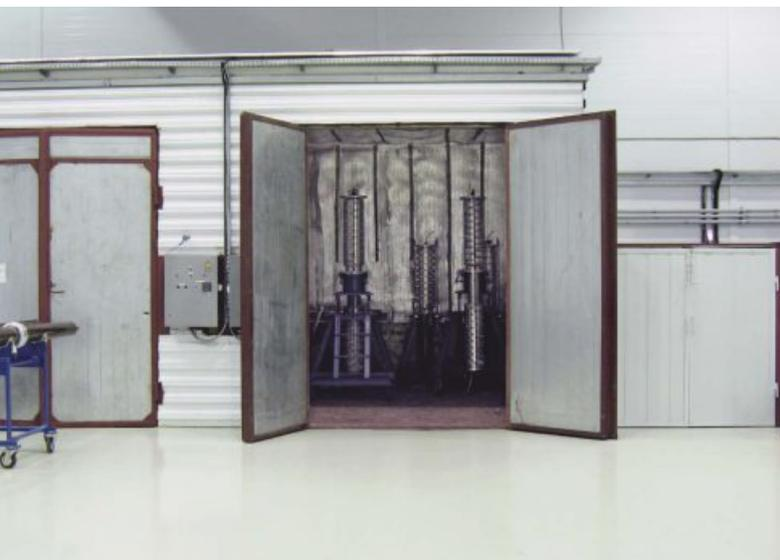
Рис. 15. Тепловое отверждение полимерной изоляции на заводе «Изолятор»
